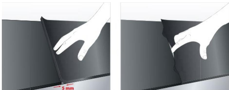
Abb. 43 Ausführung von Längs- und Stossnähten mit Plattenmaterial
