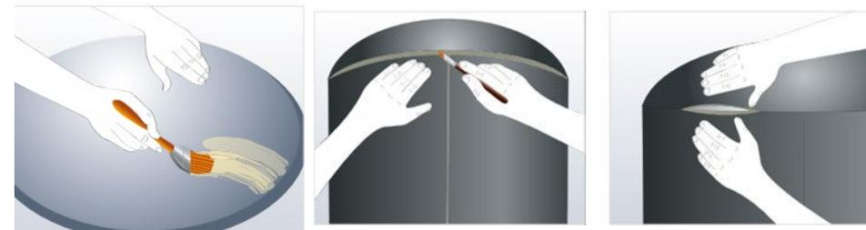
Abb. 45 Montage von Plattenmaterial an Behälterkuppeln
