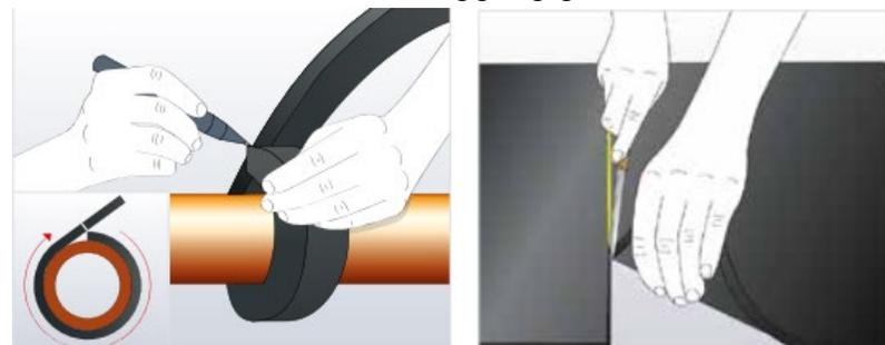
Abb. 17 Rohrumfang ermitteln und Platten konfektionieren
