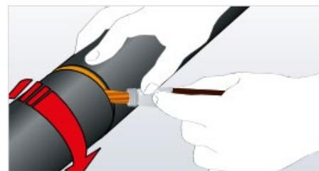
Abb. 14 Dämmabschnitte verbinden
