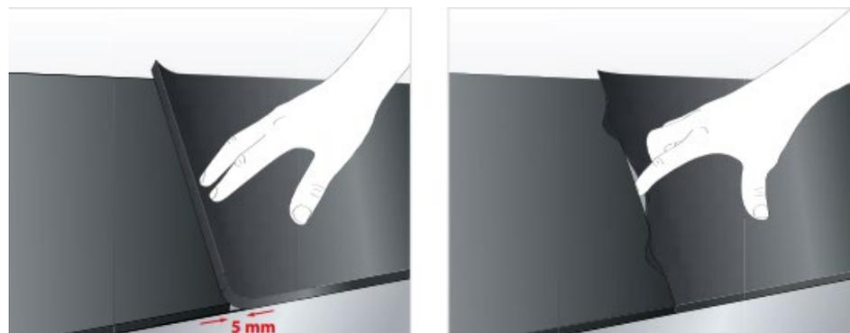
Fig. 44 Exécution de plans de joints longitudinaux et en bout avec de l'isolant en plaque
