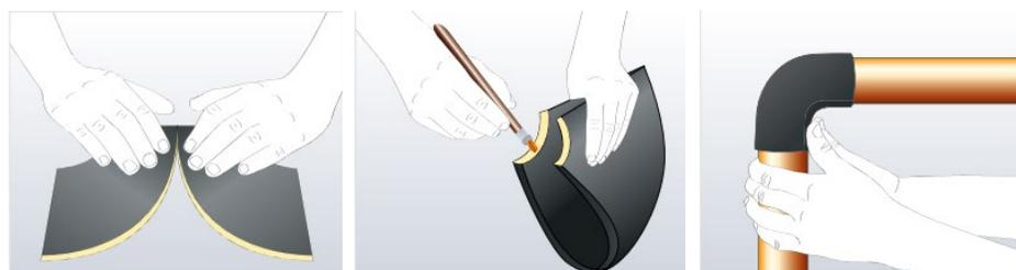
Fig. 165 Pose de l'isolation en plaque sur le coude
