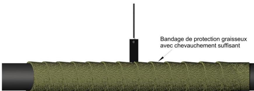
Les bandages doivent être enroulés autour des conduites en se chevauchant et leur surface lissée. Les coquilles isolantes doivent ensuite être installées suivant les directives de pose. Les masses doivent être appliquées en quantité
