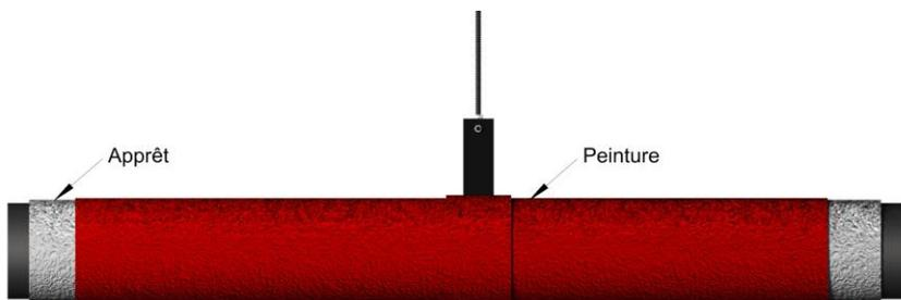
La peinture, en général à 2 composants (peinture + catalyseur), doit être appliquée sur la conduite apprêtée au préalable (le plus souvent au prix de plusieurs opérations). L'épaisseur de la couche finale est indiquée sur la fiche d'information du fabricant.
